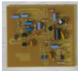
El transistor Q01 es un FET del tipo BF245 que se encuentra fácilmente en el comercio. El otro transistor que forma el oscilador, Q02, es un transistor PNP tipo BF324. Como los transistores PNP son menos corrientes, es posible utilizar otros tipos de transistor en lugar del BF324, como los que se indican en la siguiente tabla.
