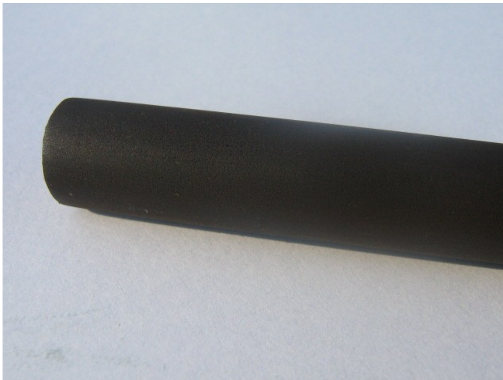
Pręt ze stali niskowęglowej St3 po 12 godz. na dworze - noc była ciepła i wilgotna.
